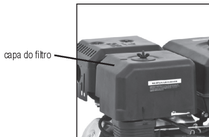
Fig. 13 – Capa do filtro de ar
